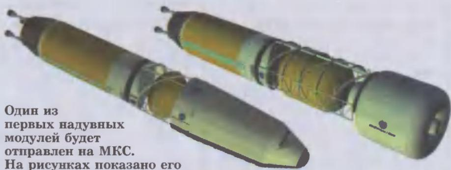
Один из первых надувных модулей будет отправлен на МКС. На рисунках показано его транспортное и рабочее положение.
